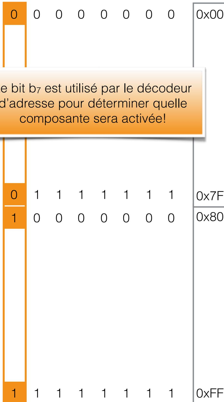
Le bit b<sub>7</sub> est utilisé par le décodeur d'adresse pour déterminer quelle composante sera activée!
